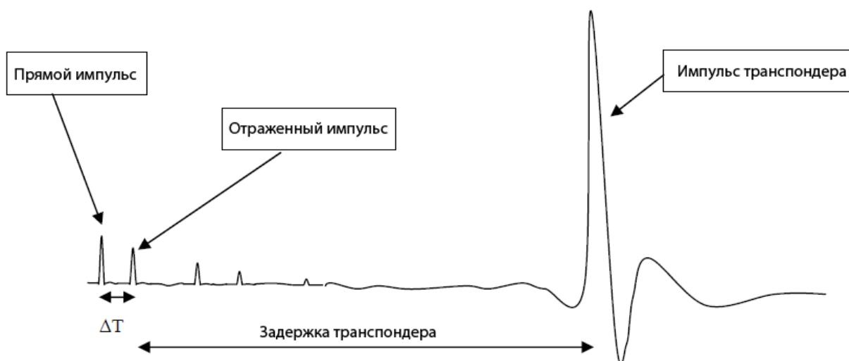
Рисунок 5: Использование ручного транспондеров с задержкой импульса
