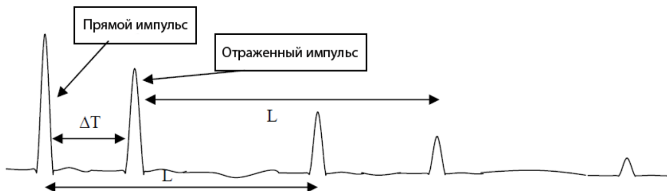
Рисунок 2: Последовательность импульсов частичного разряда со стороны проведения измерения
